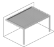
Appoggiata a parete Lame perpendicolari On facade Louvers perpendicular to the wall An der Fassade mit Lamellen senkrecht zur Wand
