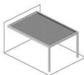
Appoggiata a parete - Lame parallele On facade - Louvers parallel to the wall An der Fassade - mit Lamellen parallel zur Wand
